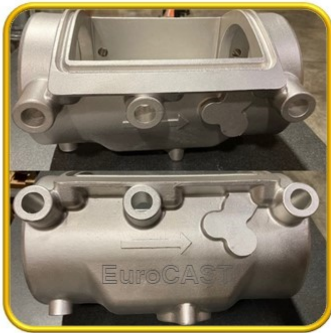
Đúc mẫu chảy thân bơm, cánh bơm
